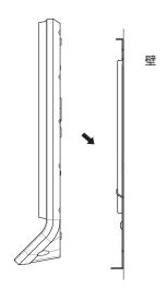
4 FaceStation F2 の製品固定ねじを回転させて、FaceStation F2 をブラケットに組み付けます。
